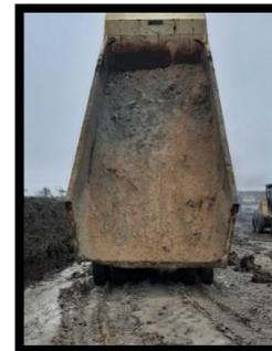
**Gambar 20.** Sisa Material *Overburden* yang Masih Tertinggal pada *Vessel*
