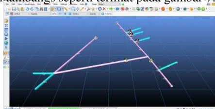
Gambar 7. Design ventilasi di software ventsim
