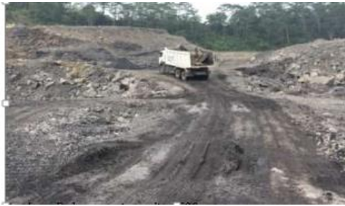
Gambar 7. Kondisi Jalan Angkut Undulating
