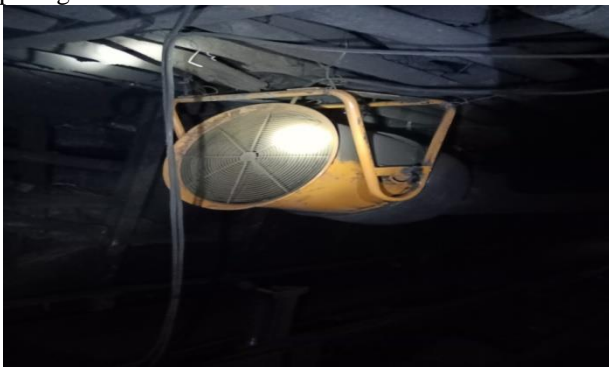
Gambar 2. Lokal Fan pada Kedalaman 217 meter
