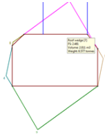
Gambar 6. Baji Setelah di Pasang Penyangga
