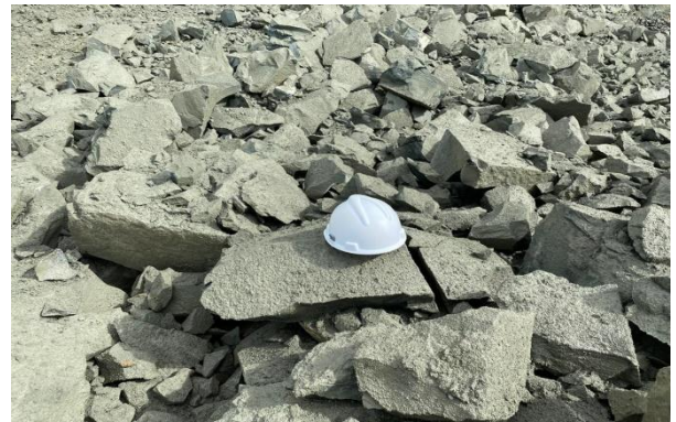
Gambar 6. Fragmentasi Hasil Peledakan Aktual PT. Dempo Bangun Mitra
