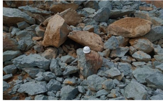
Gambar 1. Fragmentasi hasil peledakan menggunakan cutting bor dengan kedalaman stemming 1,8 m
