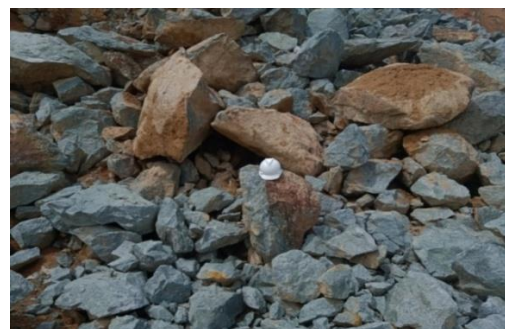
Gambar 11. Fragmentasi hasil peledakan 18 Agustus 2020 menggunakan kedalaman stemming 1,8 m
