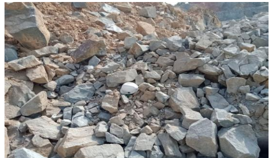
Gambar 2. Fragmentasi hasil peledakan menggunakan batu split 1-2 cm dengan kedalaman 1,8 m
