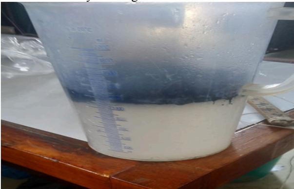
**Gambar 19.** Sel flotasi yang tercampur dengan sampel batubara
