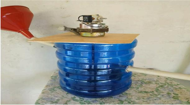
**Gambar 17.** Prototipe alat pencucian batubara
