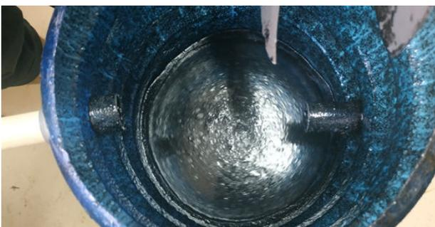
**Gambar 20.** Sel flotasi dan sampel batubara yang telah mengalami pencucian
