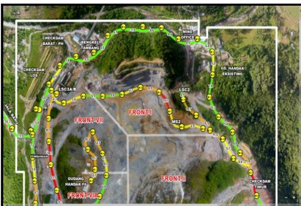
Gambar 2. Desain Layout Jalan Angkut di Front II
