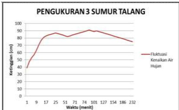
Gambar 7. Grafik Pengukuran 3 Kenaikan Air Hujan Pada Sumur Talang
