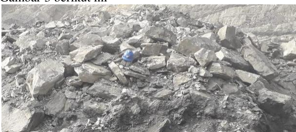
Gambar 3. Fragmentasi Batuan Hasil Peledakan Dari Penerapan Rancangan Usulan Geometri di Lapangan
