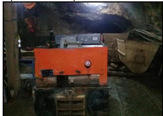
Gambar 7. Lokomotif Diesel
