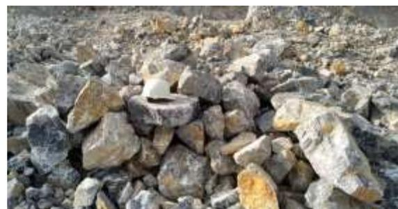
**Gambar 6.** Fragmentasi Hasil Peledakan dari Pengujian Rancangan Usulan Geometri Peledakan R.L. Ash di Lapangan.
