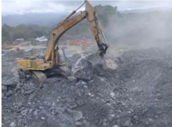
**Gambar 5.** Proses Penggalian Material Hasil Peledakan Oleh Alat Gali Muat *Excavator Komatsu pc-300*
