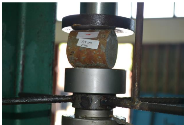
Gambar 1. Pengujian Kuat Tarik tidak langsung
