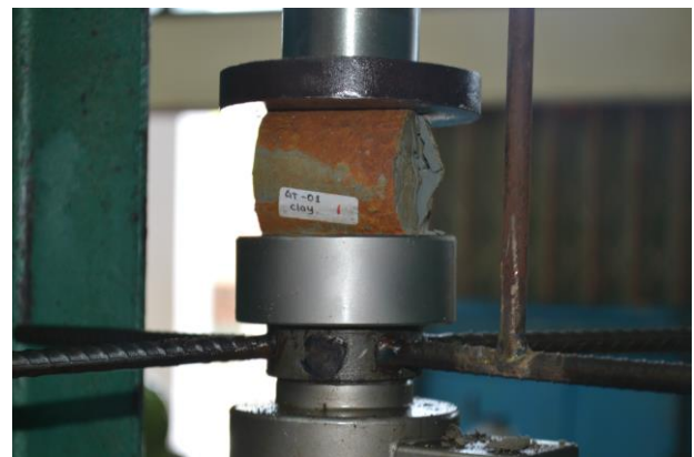
Gambar 6. Uji Kuat Tarik tidak Langsung
