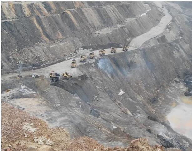
Gambar 2. Kondisi Geometri Disposal yang Sempit
