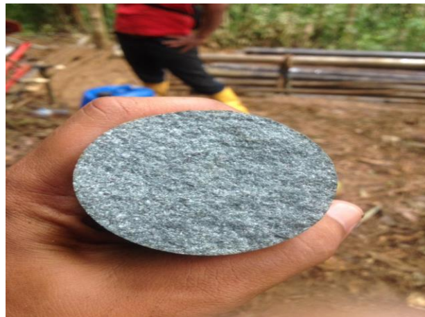
Gambar 15. Contoh Sampel Log Bor
