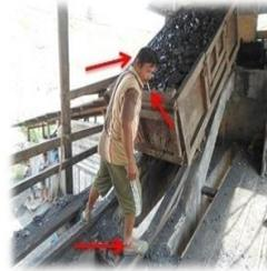
Gambar 3. Bekerja Tidak Menggunakan Alat Pelindung Diri
