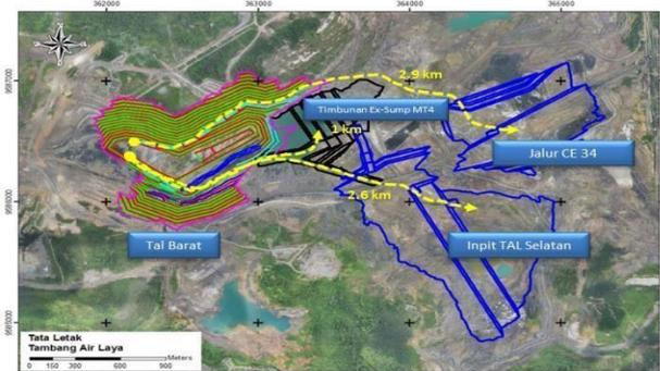
**Gambar 8.** Akses jalan angkut tanah setelah penimbunan *sump* MT4
