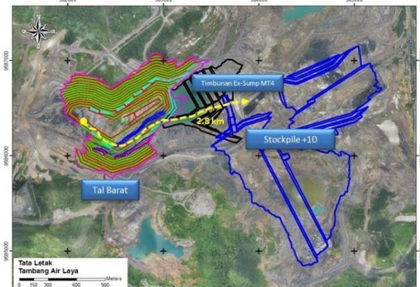
**Gambar 10.** Akses jalan angkut batubara setelah penimbunan *sump* MT4
