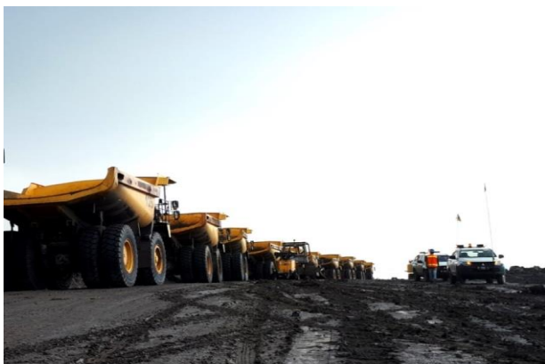
Gambar 2. Jalan Hauling yang Licin Karena Hujan
