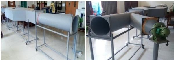
**Gambar 2.** Alat simulasi ventilasi tambang bawah tanah
