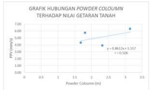
Gambar 5. Grafik Hubungan Powder Coloumn Dengan Nilai PPV
