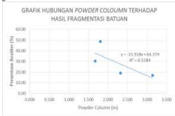
Gambar 4. Grafik Hubungan Powder Coloumn Dengan Presentase Boulder
