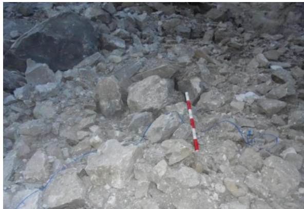
Gambar 7. Fragmentasi Peledakan dengan Geometri Aktual 17 Oktober 2018
