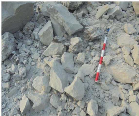
Gambar 16. Fragmentasi Peledakan dengan Geometri Aktual 22 Oktober 2018
