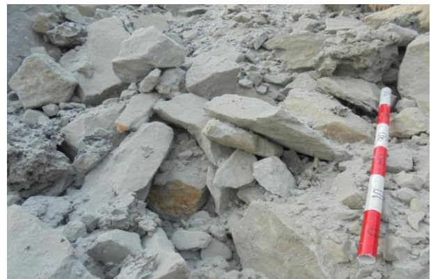
Gambar 10. Fragmentasi Peledakan dengan Geometri Aktual 19 Oktober 2018
