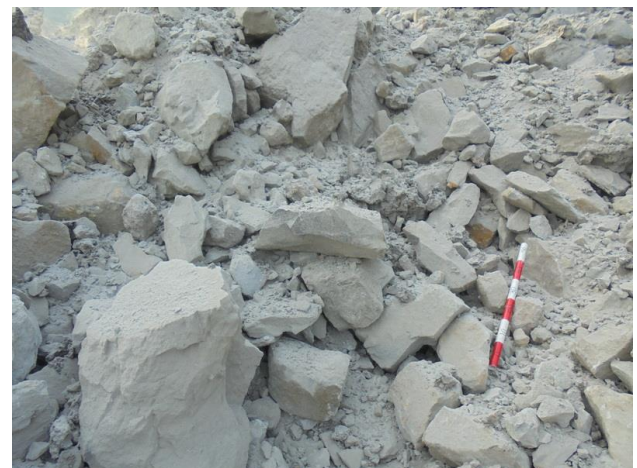
Gambar 24. Fragmentasi Batuan Hasil Peledakan dengan Geometri Usulan Kedua
