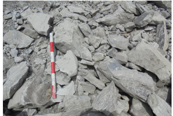
Gambar 4. Fragmentasi Peledakan dengan Geometri Aktual 15 Oktober 2018
