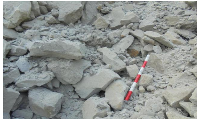
Gambar 20. Fragmentasi Batuan Hasil Peledakan dengan Geometri Usulan Pertama
