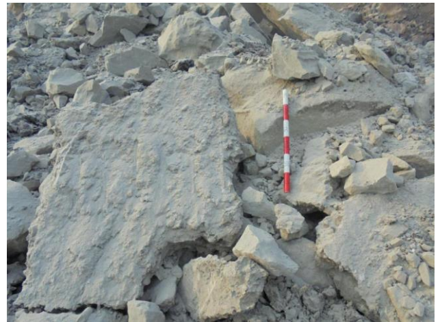
Gambar 13. Fragmentasi Peledakan dengan Geometri Aktual 20 Oktober 2018
