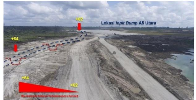
**Gambar 12.** Rekomendasi Lokasi Pembuatan Saluran Terbuka di Area *Inpit Dump* A5 Utara Tahun 2018
