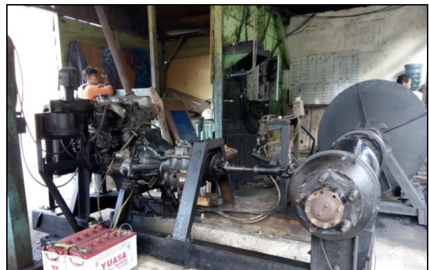
Gambar 10. Hoist Modifikasi Pengangkut Lori
