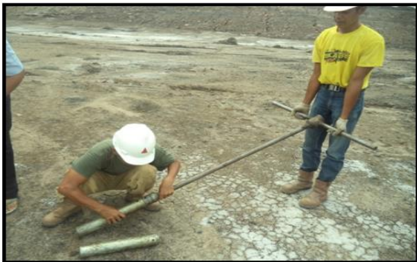
Gambar 3. Pengeboran menggunakan hand bor PT. Bukit Asam (Persero) Tbk
