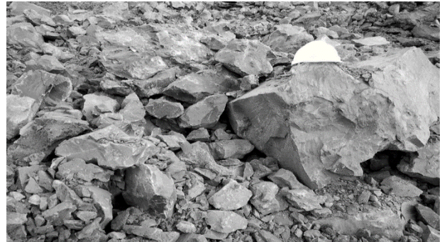
Gambar 7. Fragmentasi Batuan Hasil Peledakan Dari Penerapan Rancangan Usulan Geometri Peledakan R.L. Ash di Lapangan
