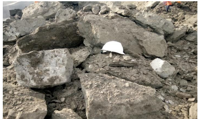
Gambar 10. Fragmentasi Batuan Hasil Peledakan Dari Penerapan Rancangan Usulan Geometri Peledakan ICI Explosives di Lapangan
