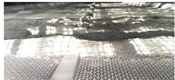
**Gambar 7.** Block di Vibrating Screen
