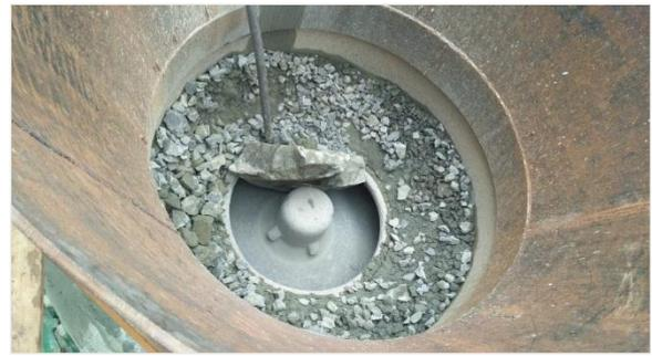
**Gambar 6.** Block di Cone Crusher
