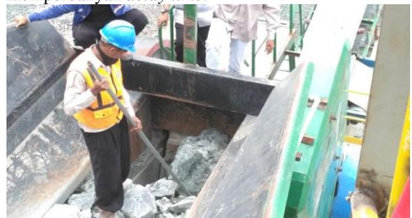
Gambar 9. Material Tersumbat di *Feeder*
