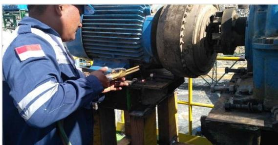
**Gambar 12.** Pemasangan Motor Pulley Baru
