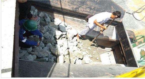
**Gambar 10.** Material Block di Feeder
