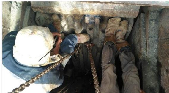
**Gambar 16.** Pembalikan Liner Jaw Crusher
