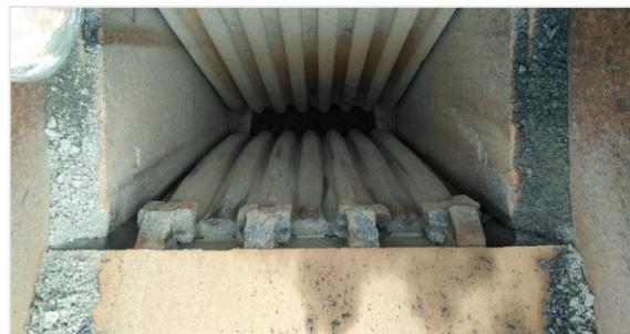
**Gambar 17.** Liner Jaw Crusher Setelah Dibalikkan
