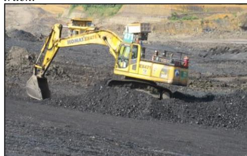
**Gambar 11.** Proses excavator sedang melakukan proses roofing
