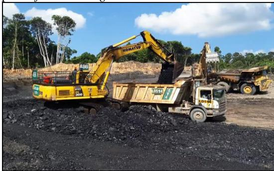
Gambar 12. Posisi alat muat dan alat angkut
