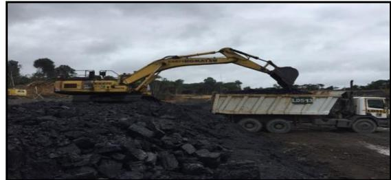
**Gambar 10.** Bentuk *front loading* batubara yang standar
