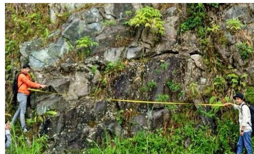
**Gambar 19.** Pengukuran Diskontinuitas Lereng
