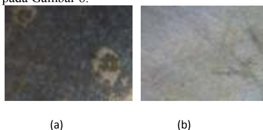
Gambar 8. Foto optik permukaan baja setelah proses korosi dalam HCl 0,01 M menggunakan Mikroskop Stereo dengan perbesaran 40 kali (a) Baja tanpa dilapisi ekstrak biji kakao (b) Baja dilapisi ekstrak biji kakao
