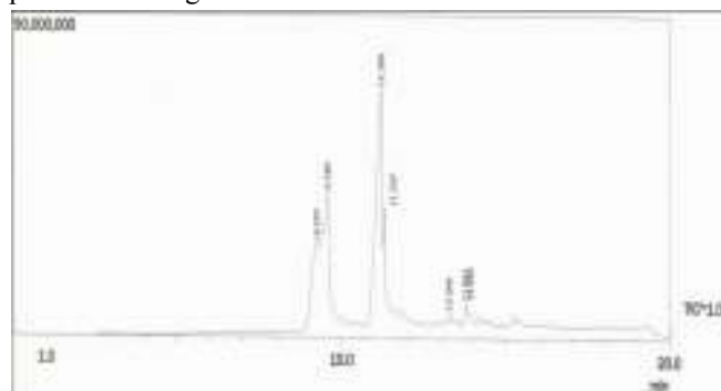
Gambar 9. Kromatogram Methylene Blue Hasil Degradasi dengan menggunakan GC-MS
