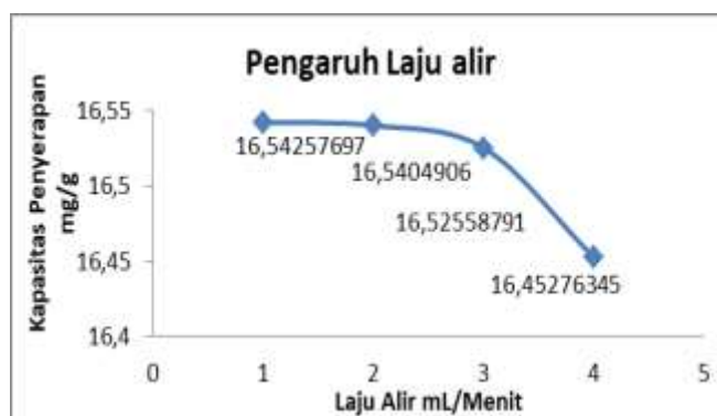
Gambar 3. Pengaruh laju alir terhadap penyerapan ion logam Cd 2+ pada kulit langsung.
