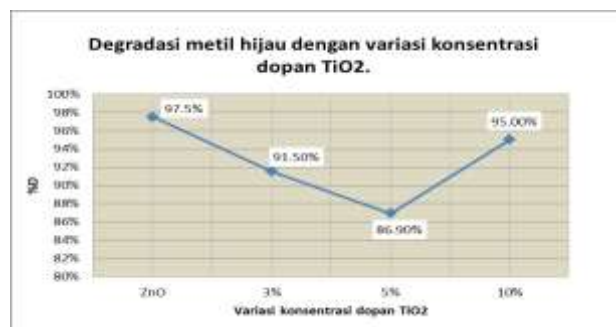
Gambar 3. Grafik pengaruh variasi konsentrasi dopan \text{TiO}_2 terhadap degradasi Metil hijau secara fotolisis..
