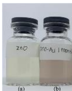
Gambar 1. (a) Nanopartikel ZnO (b) Nanopartikel ZnO/Au
