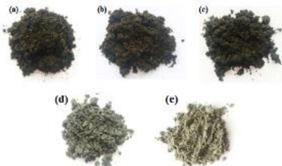
Gambar 2. Hasil Karbonisasi Batang Jagung (a) KBJ 250, (b) KBJ 300, (c) KBJ 350, (d) KBJ 400 dan (e) KBJ 450
