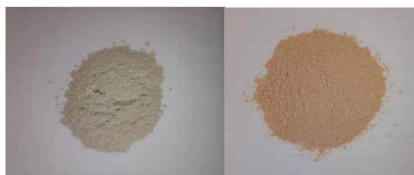
Gambar 2. Tanah Napa Sebelum dan Sesudah Kalsinasi
