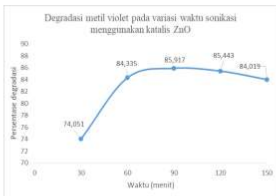
Gambar 1. Degradasi metil violet pada variasi waktu menggunakan metoda sonolisis dengan katalis ZnO 0,05 g.
