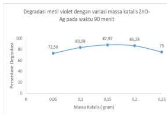
Gambar 2. Degradasi matil violet pada variasi massa katalis ZnO – Ag 10% menggunakan metoda sonolisis
