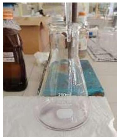
Gambar 8. Proses penyaringan karbon aktif dari iodine dan titrasi menggunakan Na<sub>2</sub>S<sub>2</sub>O<sub>3</sub> hingga bening
