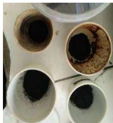
Gambar 6. Analisa kadar zat mudah menguap
