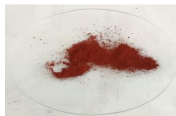
Gambar 3. Pigmen merah hematit yang dikalsinasi pada suhu a). 650 °C, b). 700 °C, c). 750 °C, dan d). 800 °C.
