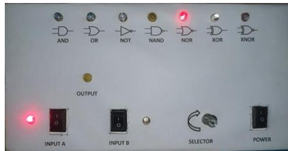
Gambar 6. Pengujian NOR
