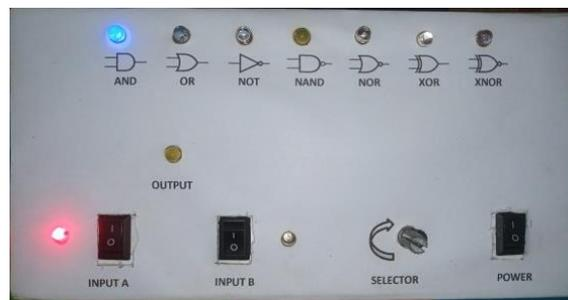
Gambar 2. Pengujian AND
