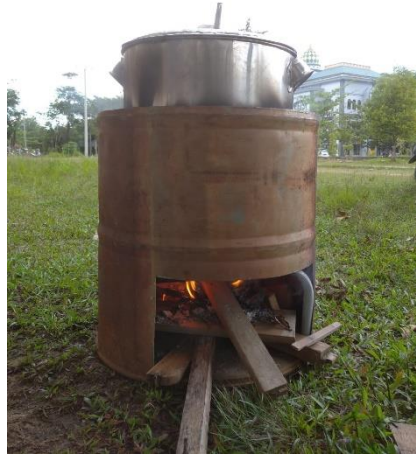
Gambar 3. Proses Pembakaran Tungku Pirolisis
