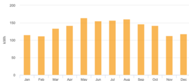
Gambar 15. Produksi energi rooftop solar panel sistem 2200VA
