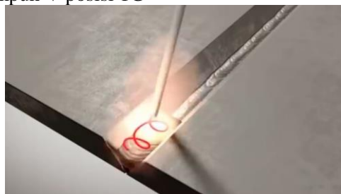
Gambar 5. Pengelasan kedua pada Las SMAW Sambungan las Kampuh V Posisi 1G
