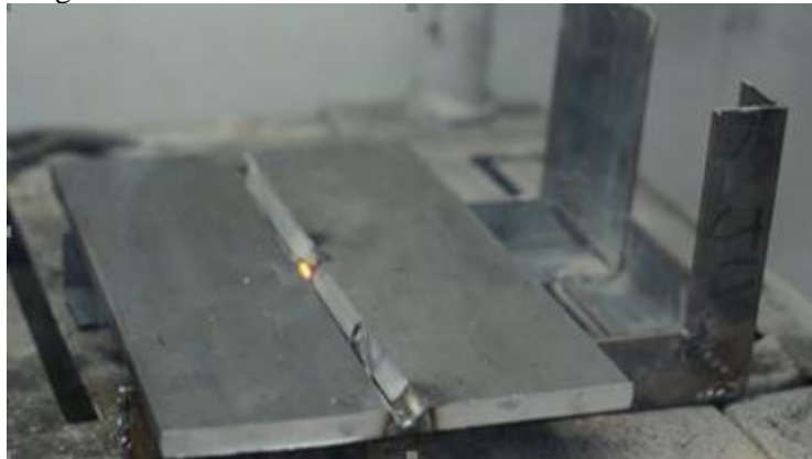
Gambar 3. Hasil Tack welding pada Las SMAW Sambungan Las Kampuh V Posisi 1G
