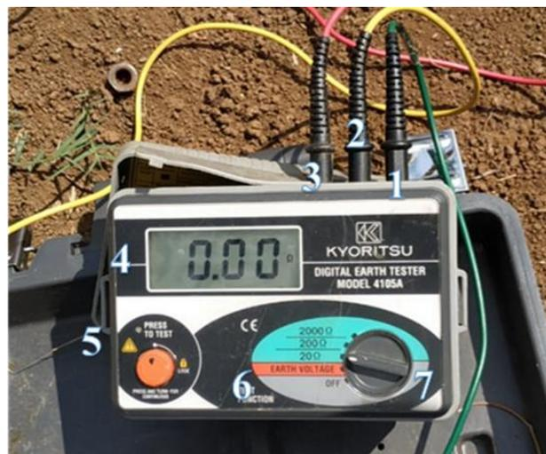
**Gambar 4. *Earth Resistance Tester* dengan Merk Kyoritsu**
