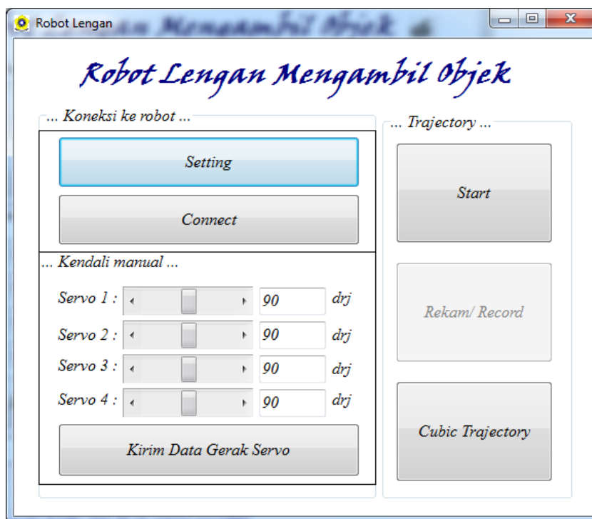
Gambar 4. Tampilan program komputer dalam mengendalikan pergerakan robot lengan.
