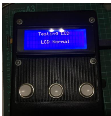
Gambar 15. Hasil Pengujian Rangkaian Driver LCD
