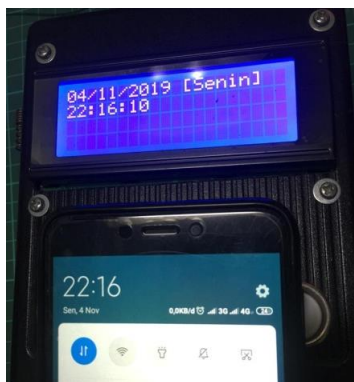
Gambar 19. Hasil Pengujian Rangkaian RTC
