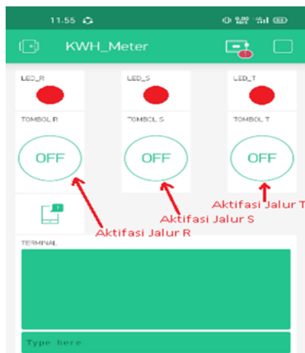
Gambar 9. Aktifasi lampu indikator pada Blynk
