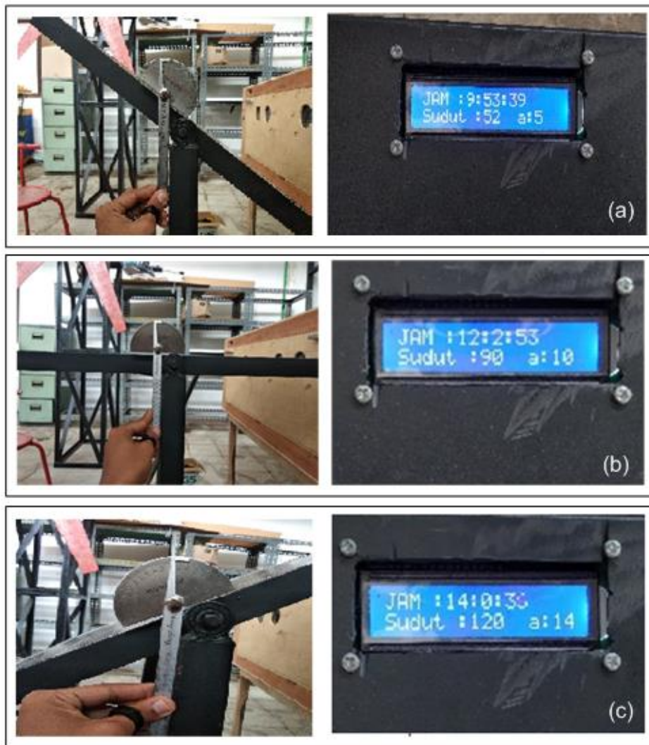
Gambar 5. Hasil pengujian solar tracker pada pagi, siang dan sore
