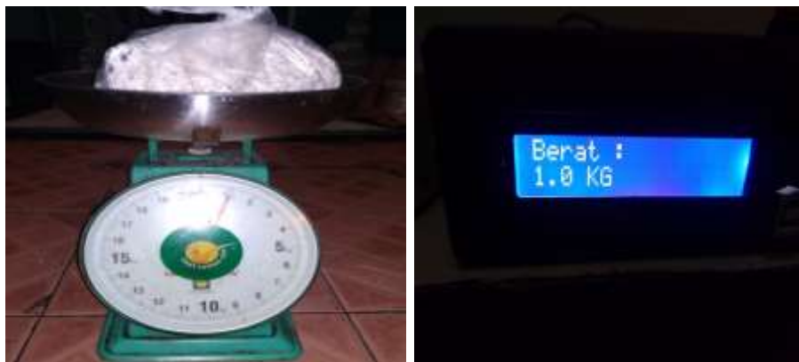
Gambar 6. Hasil pengujian Sensor loadcell dengan Timbangan Manual
