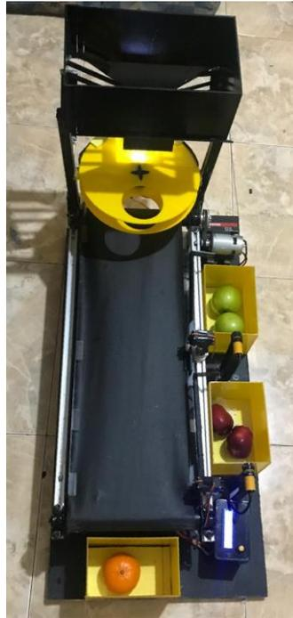
Gambar 8. Alat Sortir Buah Apel Otomatis
